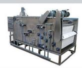
滤布宽度(Belt width):500-2000 mm 污泥处理量(Treating capacity):2.56-28.2 m3/h 主体材质(Material):SUS304
