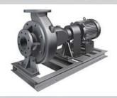
功率(Power):0.75-110 kW 口径(Outlet):50-400 mm 扬程(Head):6-45 m 流量(Capacity):10-2500 m<sup>3</sup>/h 材质(Material):FC200、SCS13、SCS14
